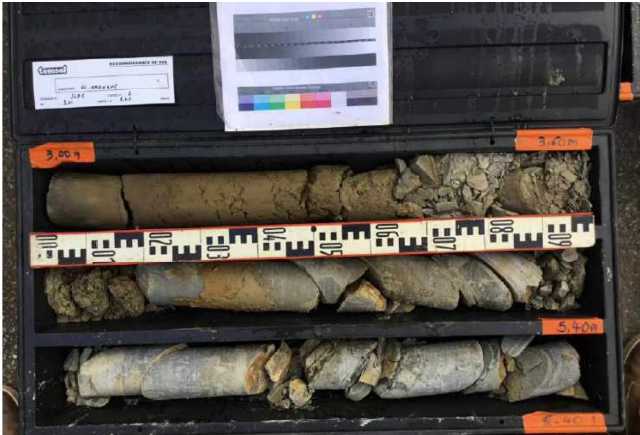
caisse n°2 : de 3,00 à 6,40 m
