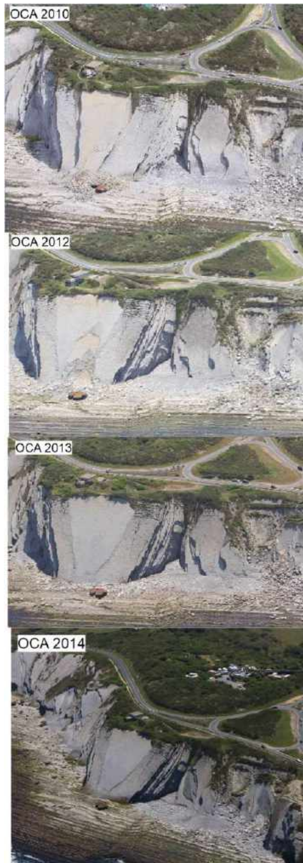
Figure 36 : Erosion par mer du cône d'éboulis entre 2010 et 2014 – secteur 6
