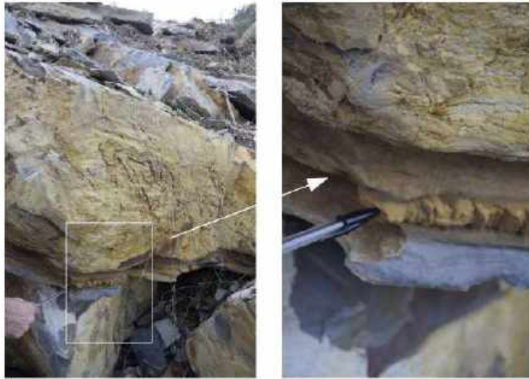
Inter-banc marno-argileux à la base des dalles calcaires (ici dalle superficielle de 80 cm d'épaisseur)
