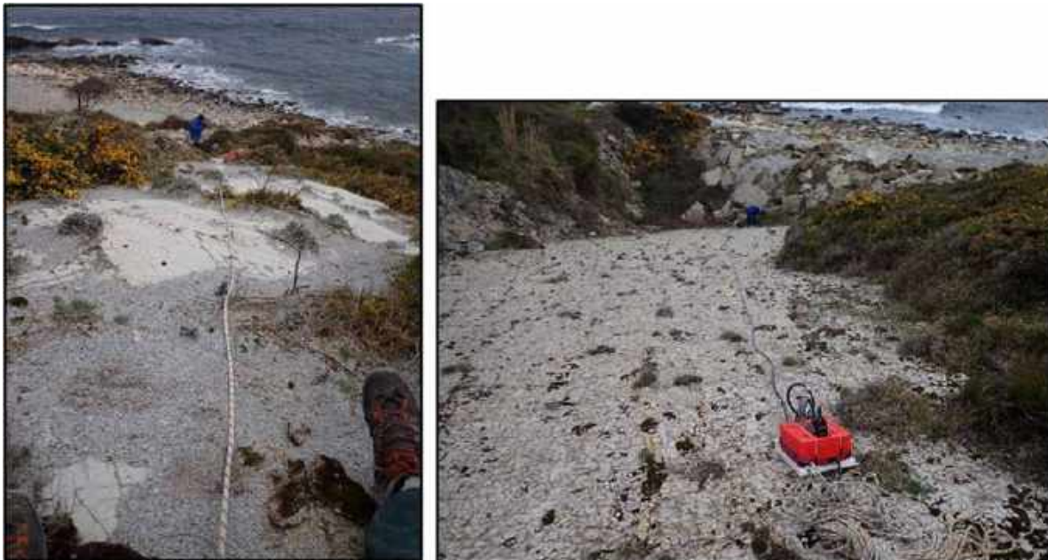
Figure 26 : Mise en œuvre du radar géologique
