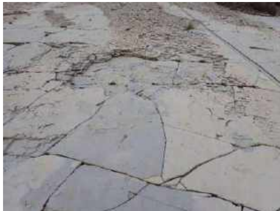
Figure 16 : Rocher bréchié, écaillage superficiel (profil 15B)
