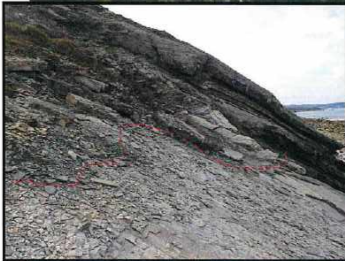
Écroulement pseudo-rocheux en cours – 1.5 m d'épaisseur (Cerema 02-2021)
